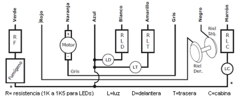
**EN CASO DE USAR LEDs:** El positivo de éste (patita larga) debe ir conectado al cable azul, que es el común positivo de todos los accesorios.
